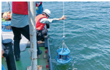
海底に設置する地震計の設置状況。地震計設置方法など、これまで培ってきた海洋調査技術のノウハウを活かした新技術を確認しました。
