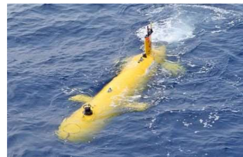
▲AUV（自立型無人潜水機）による海底付近の高密度・高精度の地形・地質等調査。
