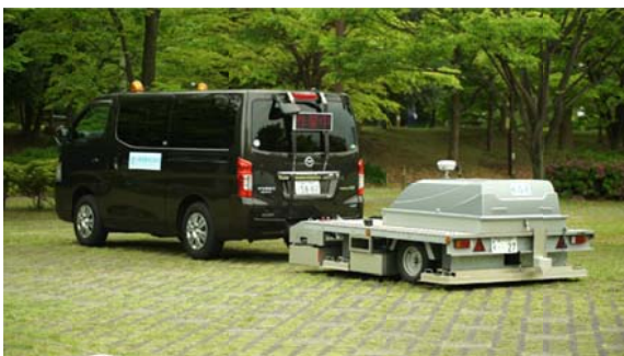
写真1:川崎地質の路面下空洞探査の様子
