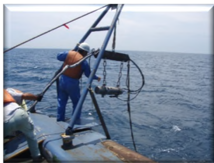
エアガン投入状況
