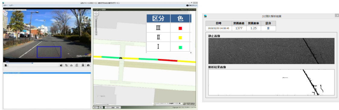
図2 ドライブレコーダー映像と地図の連動、およびひび割れ情報表示イメージ
