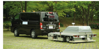
Fahrerloses, fahrerloses Erkundungsfahrzeug mit Bodenradar
