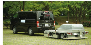
Xe kéo thăm dò radar xuyên đất
