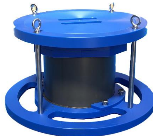
海底微動計 (直径50cm, 耐圧水深200m)
