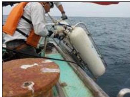
ブーマー投入状況
