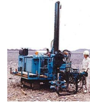
◎回転式大型動的貫入試験 160(m/日)の調査能力 高速サンプリングも可能
