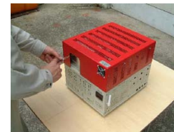
◎揮発性有機化合物 (VOC) 対象の分析 GC/PID・DELCDを用いた現場分析
