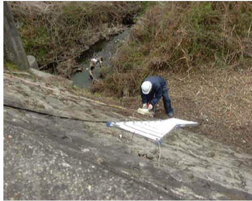
探査風景 (小型軽量装置のため急斜面でも計測可能)
