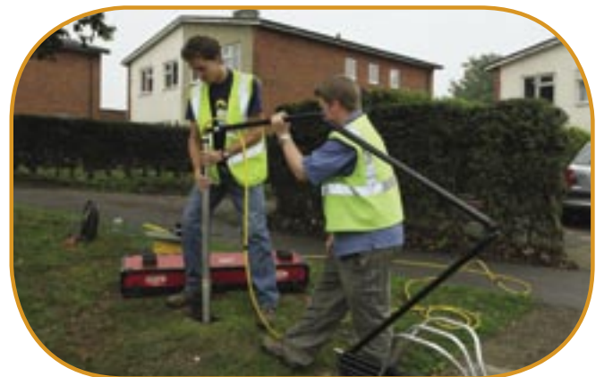
☀ 旧ヨーク鉱山の測量による地面陥没調査
