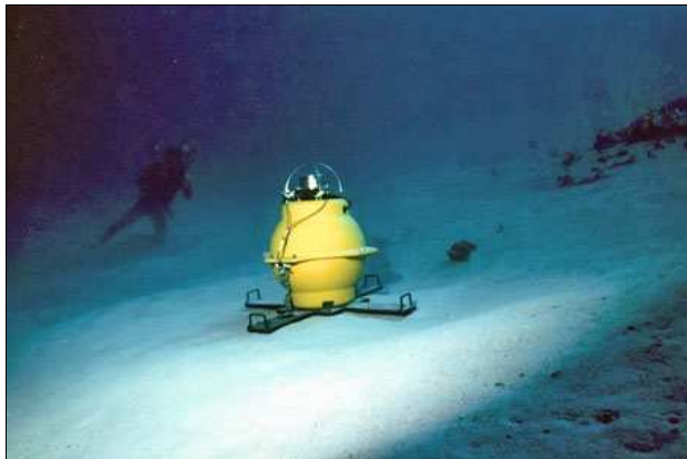
海底地震計の設置状況
