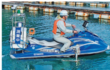
測深機と測位装置を搭載しても、水上バイクのコンパクトなサイズ感と操縦の細やかな操作性はそのままに、水深50cmの浅瀬から200mの深さまで測定
