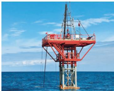
水深35mの地点での鋼製檣を使用したボーリング実施状況。安全施設の追加装備など改良を行ったほか、大型の鋼製檣を開発し、現在水深50mまで対応可能となりました。
