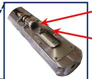
孔壁確認用 CCDカメラ CCD Camera for viewing a borehole
