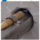
削孔径は φ 42mm以上 試験装置を強度を知りたい深度に挿入
