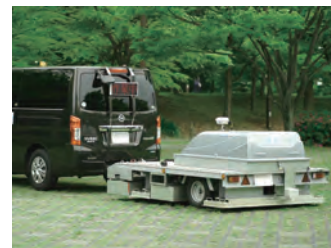
▲深層空洞調査に最適な「牽引型」
