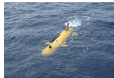
◀AUV(自律型無人潜水機)で海底近くまで潜水し測定
