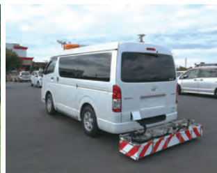
▲浅層部路面下空洞調査に「車載型」
