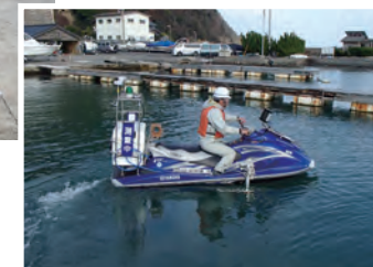
水上バイクに測深機と測位装置を搭載し、あらゆる水域へ▶
